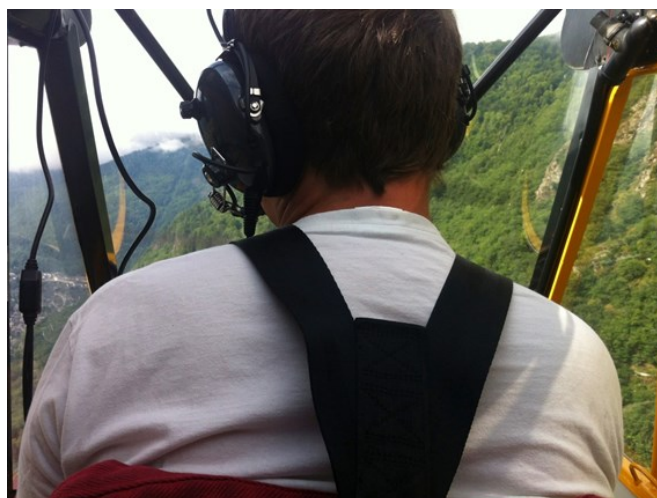
Figure 3 : photographie illustrant la visibilité vers l'avant depuis la place arrière d'un PA18 (Source : BEA)
