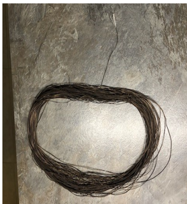
Figure 4 : fil retrouvé accroché à l'aile (Source : BEA)
