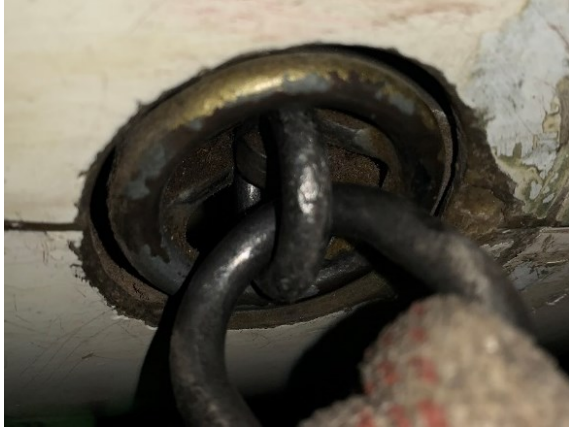
Figure 3: crochet en position FERME (Source : BEA)
