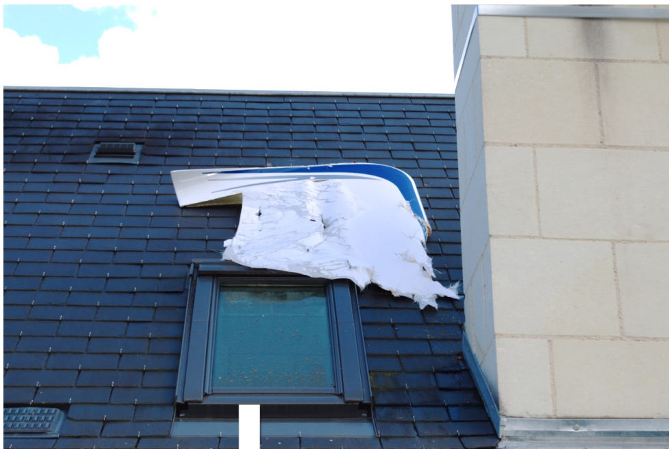
Figure 6 : extrémité de l'aile gauche du 37AHH, vue de l'extrados (Source : SRTA)
