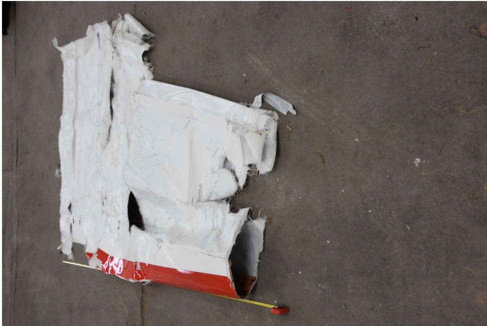
Figure 5 : revêtement de l'extrémité de l'aile gauche du F-BXEU (Source : SRTA)
