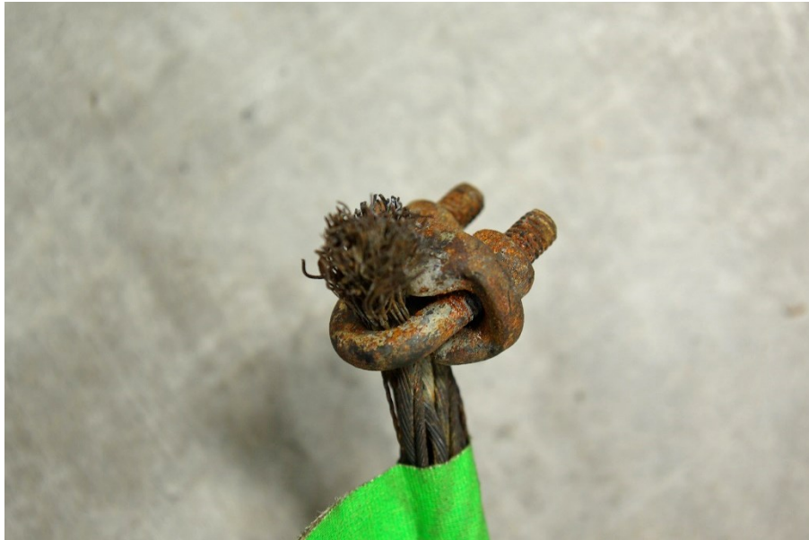
Figure 15 : extrémité rompue d'un câble avant, cassure située côté parachute (Source : BEA)
