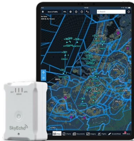
Figure 43 : boîtier SkyEcho et visualisation sur tablette (Source : Internet)
