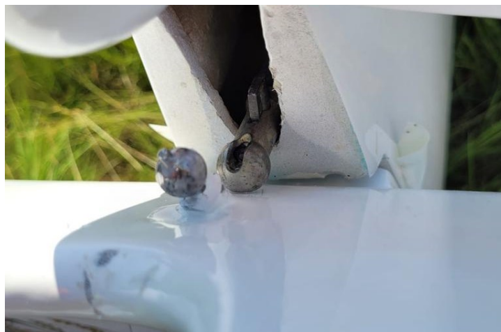
Figure 2 : liaison rotule retrouvée déconnectée (Source : GTA)
