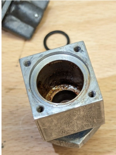
Figure 4 : robinet de purge droit ouvert (Source : BEA)
