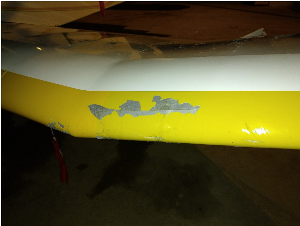
Figure 1 : dommages sur le bord d'attaque et l'extrados (Source : BGTA)
