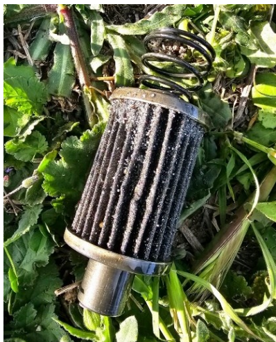
Figure 13 : Filtre à huile colmaté
