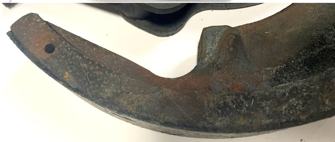
Figure 10 : aspects des garnitures du tambour d'embrayage du F-GKTR (Source : BEA)
