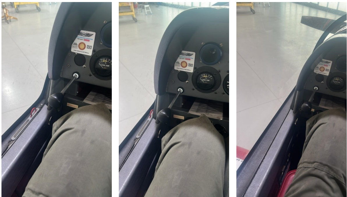
Figure 3 : photo du levier de largage en place gauche verrière fermée à gauche, ouverte de 8 cm au milieu et ouverte de 30 cm à droite (Source : BEA)
