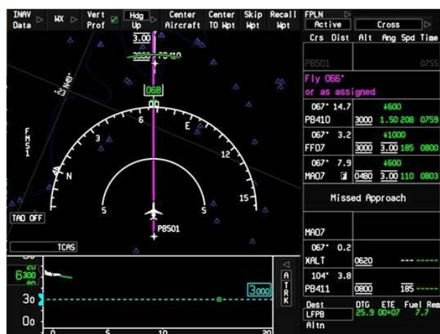
Figure 15 : MDU affiché à l'équipage après le passage de PB501 (Source : Dassault Aviation)
