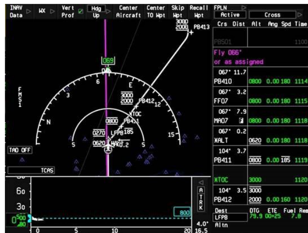
Figure 17 : MDU affiché à l'équipage après l'interruption de l'approche (Source : Dassault Aviation)
