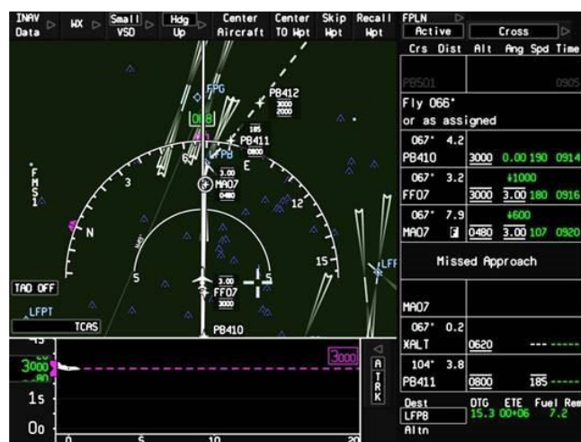
Figure 16 : MDU affiché à l'équipage après l'armement de l'approche et de l'engagement du mode LOC (Source : Dassault Aviation)
