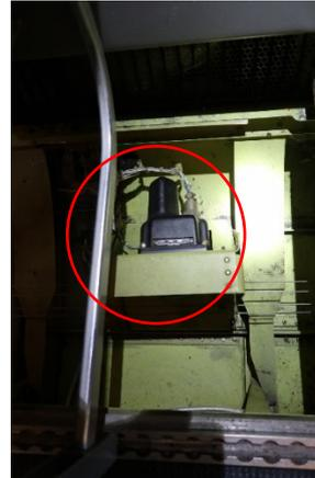
Figure 7 : servomoteur électrique et câbles du trim électrique (Source : BEA)
