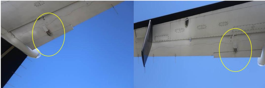
Figure 5 : vue extérieure des vérins de compensateur (Source : BEA)
