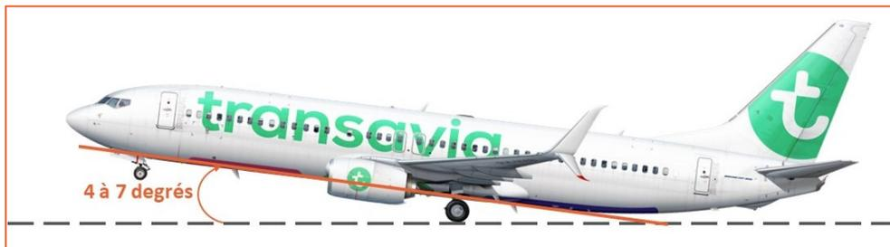
Figure 18 : géométrie du Boeing 737-800 à l'atterrissage.
