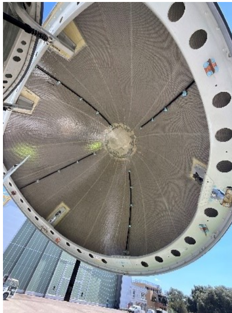
Figure 3 : dommages sur la face interne du radôme (Source : Air France)
