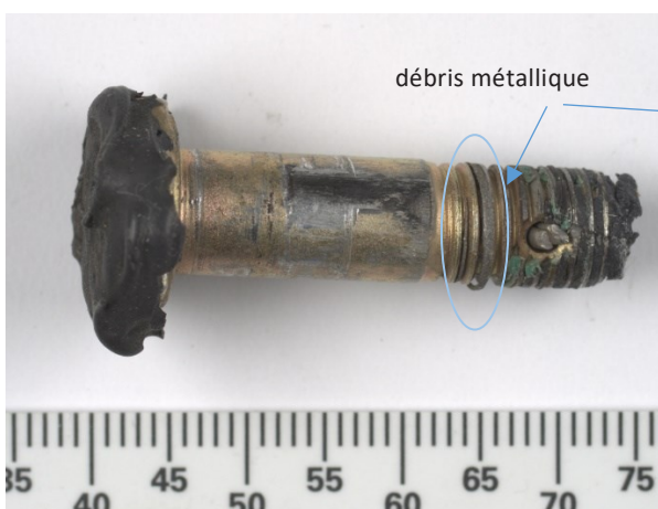
Figure 10 : vis en position arrière bas (Source : BEA)
