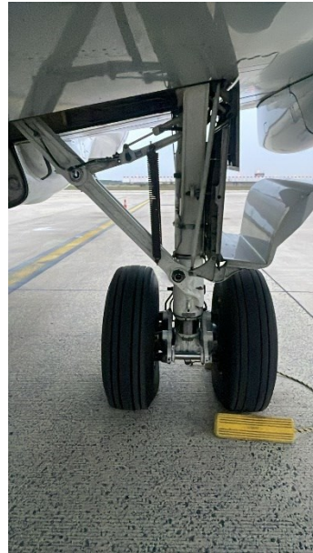
Figure 3 : train principal gauche en position normale, vue de l'avant vers l'arrière (Source : BEA)
