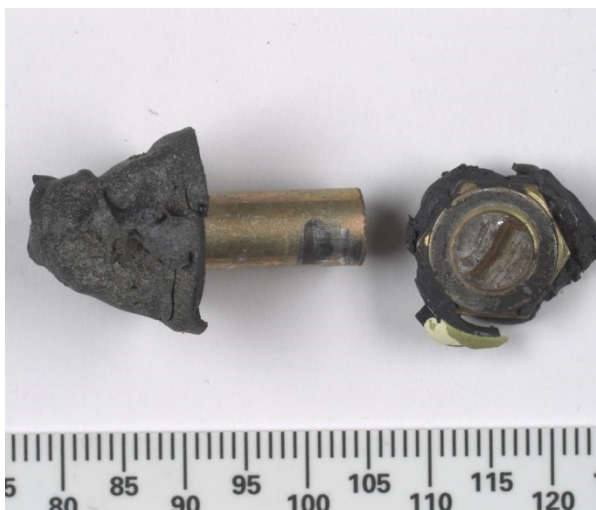
Figure 8 : boulon en position arrière haute (Source : BEA)
