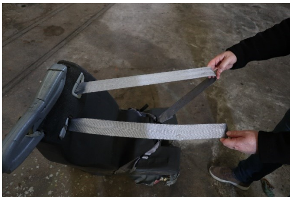
Figure 14 : harnais d'épaules du siège avant gauche (Source : BEA)
