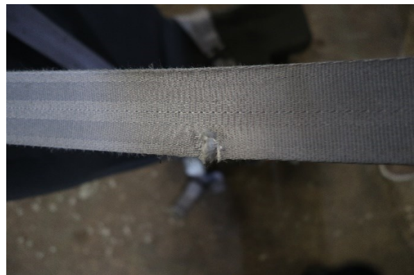
Figure 15 : marque sur le harnais droit du siège avant gauche (Source : BEA)
