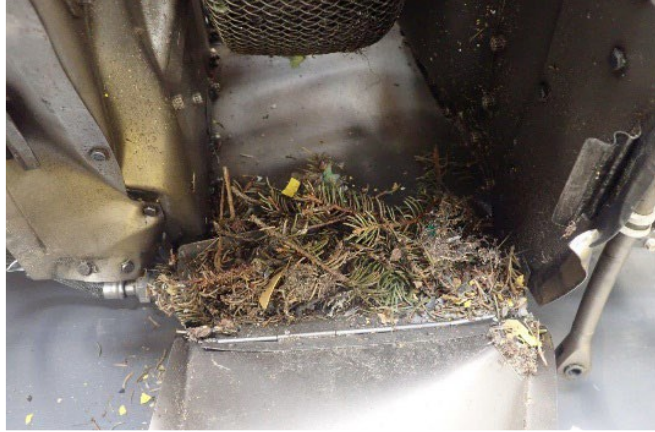
Figure 32 : débris observés dans le plénum du moteur droit
