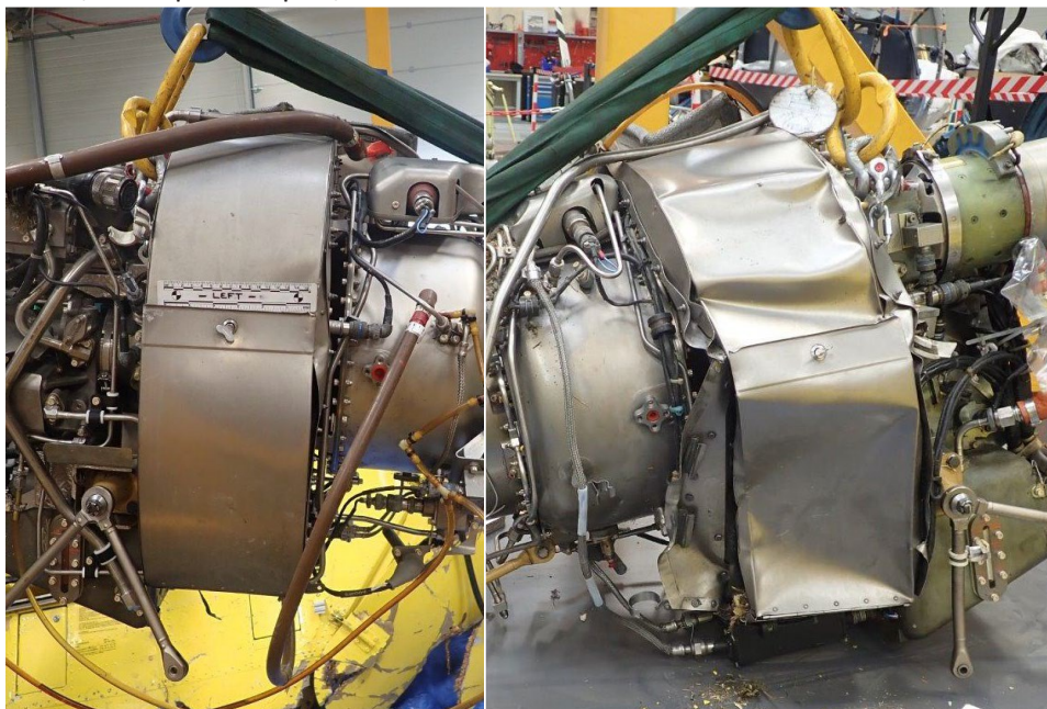
Figure 30 : plénums des moteurs gauche et droit
