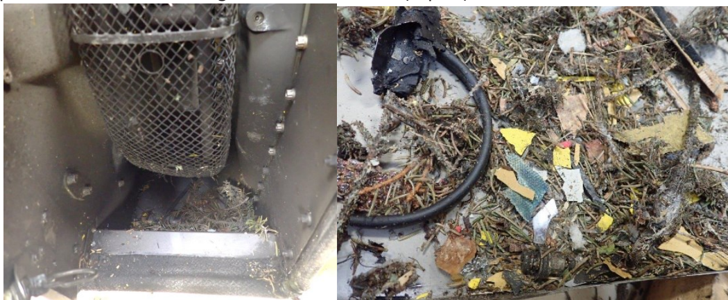
Figure 31 : débris observés dans le plénum du moteur gauche
