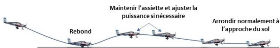
Figure 2 : technique de pilotage en cas de rebond (Source : manuel d'exploitation de Mermoz Academy)
