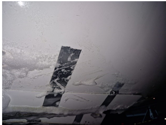
Figure 2 : bandes adhésives présentes sur les trappes du train avant (Source : R&O)
