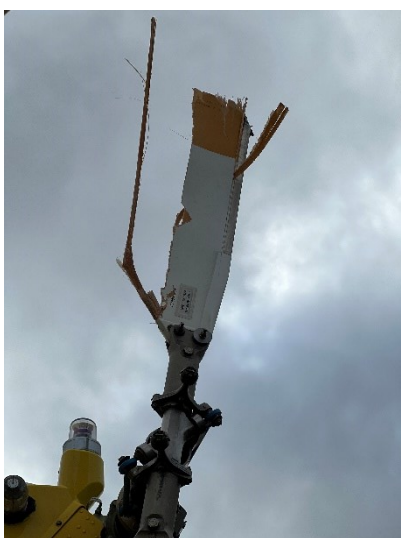
Figure 4 : pale délaminiée (Source : BEA)
