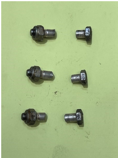
Figure 6 : vis rompues (Source : BEA)
