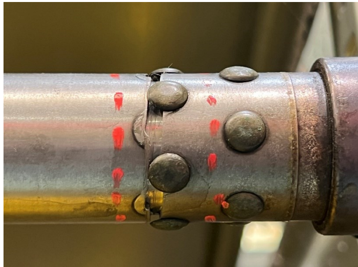
Figure 7 : rivets rompus (Source : BEA)
