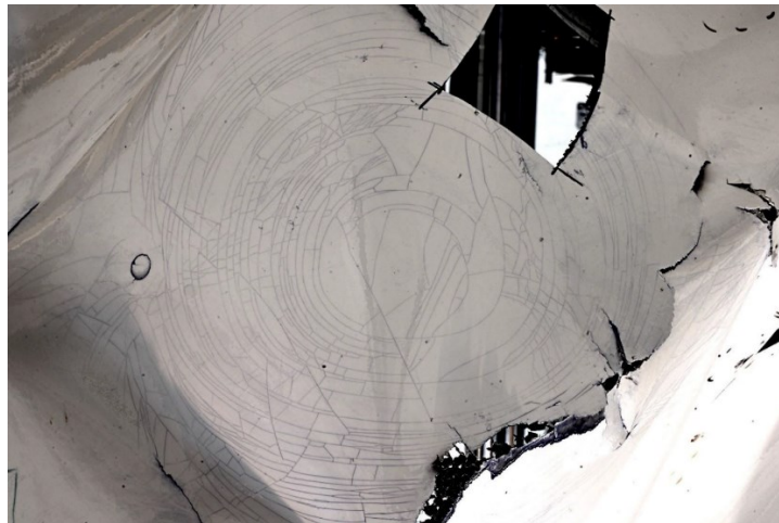
Figure 23 : présence de fissures concentriques dans la peinture (Source : BEA)
