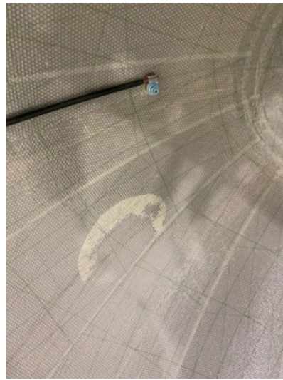
Figure 37 : choc aviaire et décollement de la peau interne sur un radôme d'A318 (Source : Air France)
