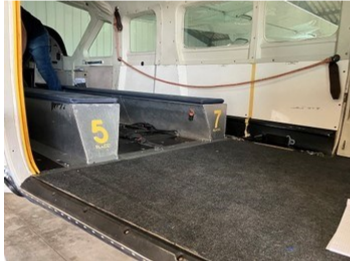
Figure 7 : agencement à l'intérieur de la cellule en configuration largage de parachutistes (Source : BEA)
