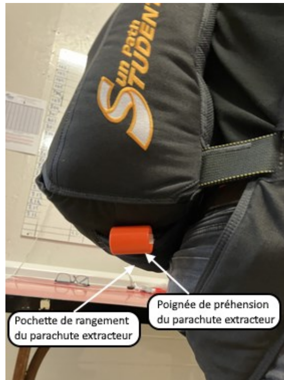
Figure 5 : positionnement de la pochette de rangement d'un parachute extracteur sur un parachute du même type (Source : BEA)
