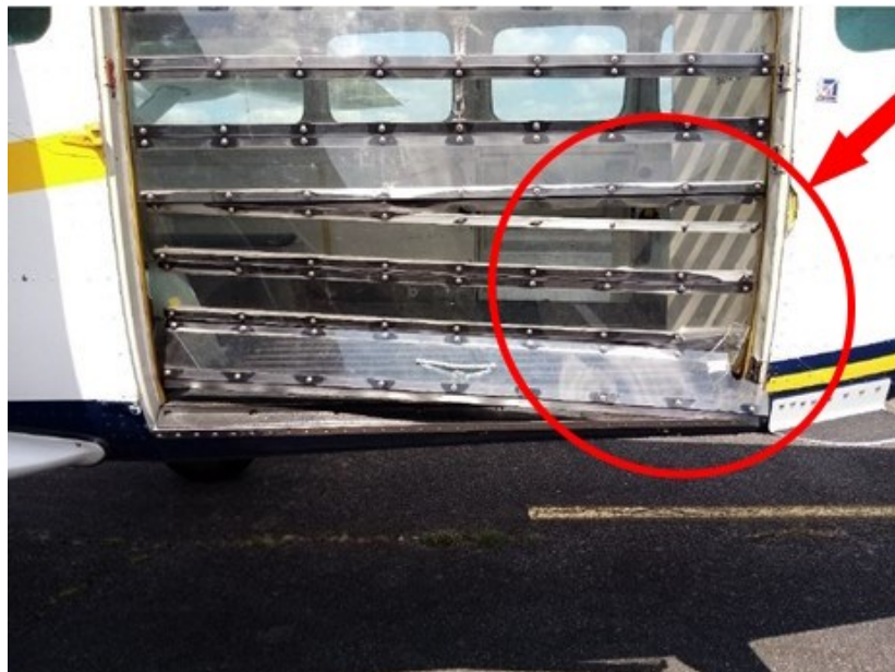
Figure 1 : dommages sur la porte (montant et lames du rideau) (Source : école de parachutisme)
