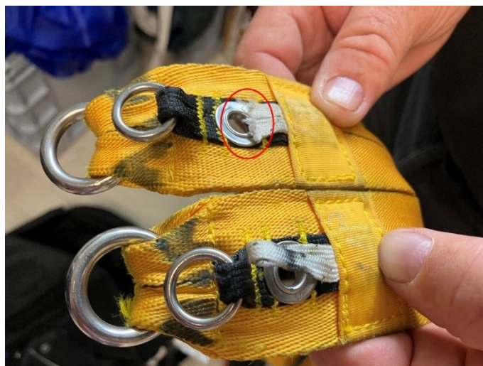
Figure 3 : vue des élévateurs gauche (en bas) et droit (en haut) avec la rupture de la bouclette textile (Source : BEA)
