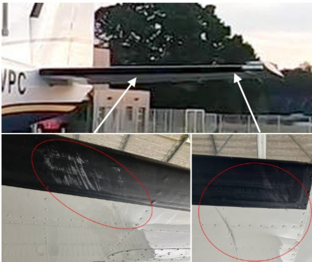
Figure 2 : traces sur le bord d'attaque et l'intrados du plan fixe horizontal arrière gauche (Source : BEA)
