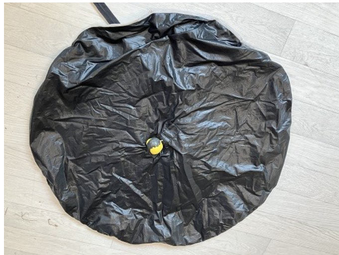
Figure 6 : parachute extracteur et sa poignée de préhension en cuir (Source : BEA)
