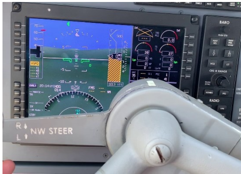
Figure 10 : photo de la commande du NWS alignée prise alors que le train n'est pas verrouillé dans la position centrée (Source : BEA)
