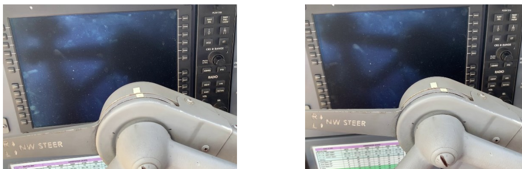
Figure 9 : photos de la commande du NWS alors que le train est verrouillé dans la position centrée (Source : BEA)
