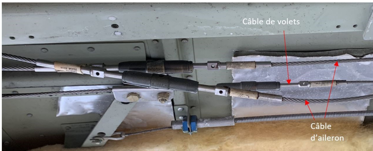
Figure 7 : vue des câbles d'aileron et du câble des volets, côté droit (détail D, Figure 1 ) (Source : BEA)
