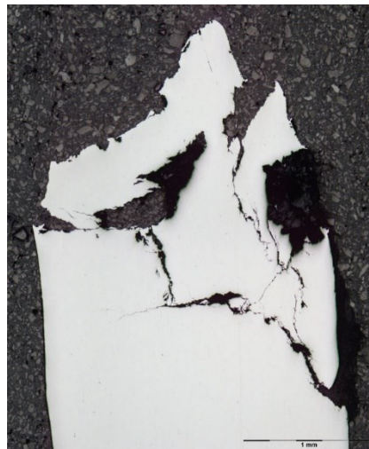
Figure 14 : coupe micrographique au droit de la rupture du raccord du câble de commande de volet gauche – présence de fissures ramifiées sous la surface de rupture (Source : BEA)
