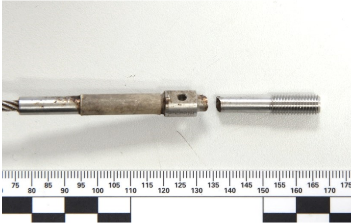
Figure 9 : raccord du câble de la commande d'aileron (Source : BEA)
