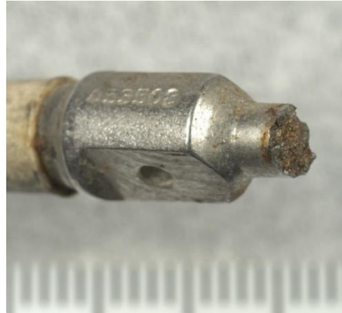
Figure 13 : surface de rupture du raccord (Source : BEA)
