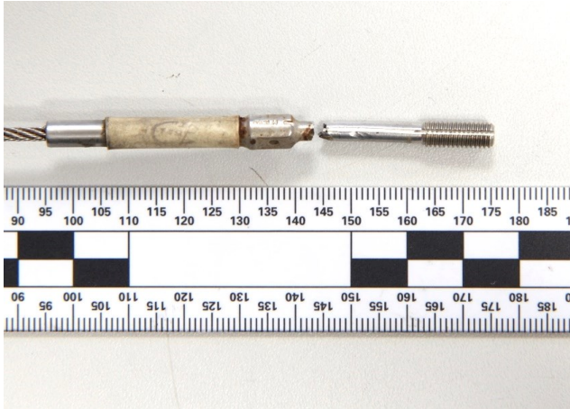
Figure 12 : raccord du câble de commande des volets rompu, côté gauche (Source : BEA)
