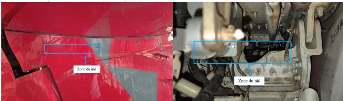
Figure 2 : zone où les nids ont été retrouvés puis enlevés (Source : Air Tahiti)
