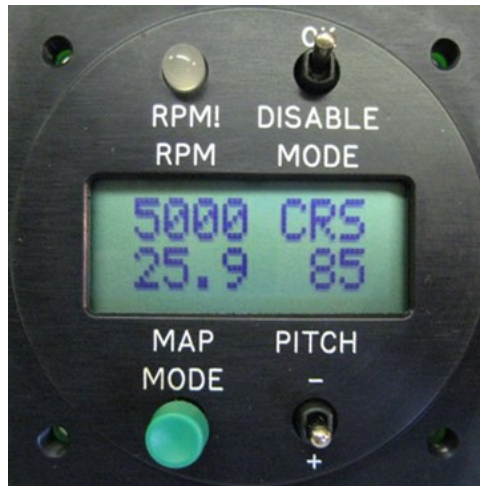
Figure 2 : écran du régulateur CSC-1 (Source : Smart Avionics)
