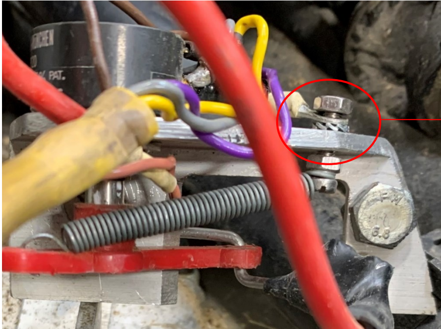
Figure 3 : cosse du conducteur de masse non serrée (Source : BEA)
