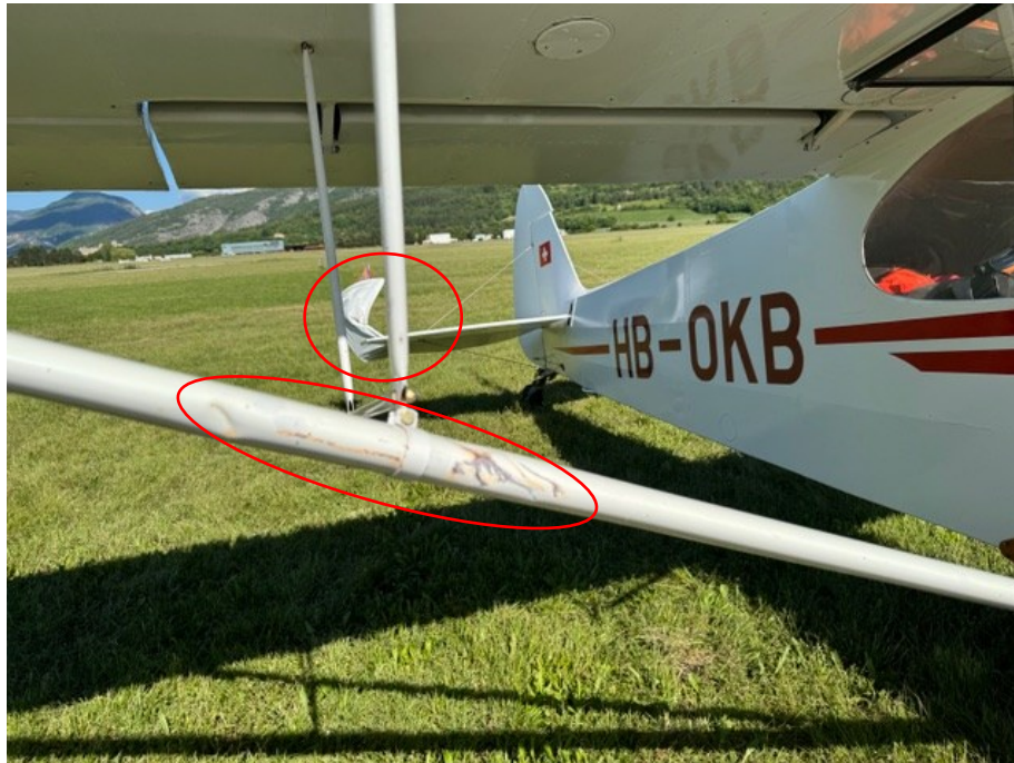
Figure 2 : dégâts observés sur l'avion (Source : instructeur, annotations BEA)
