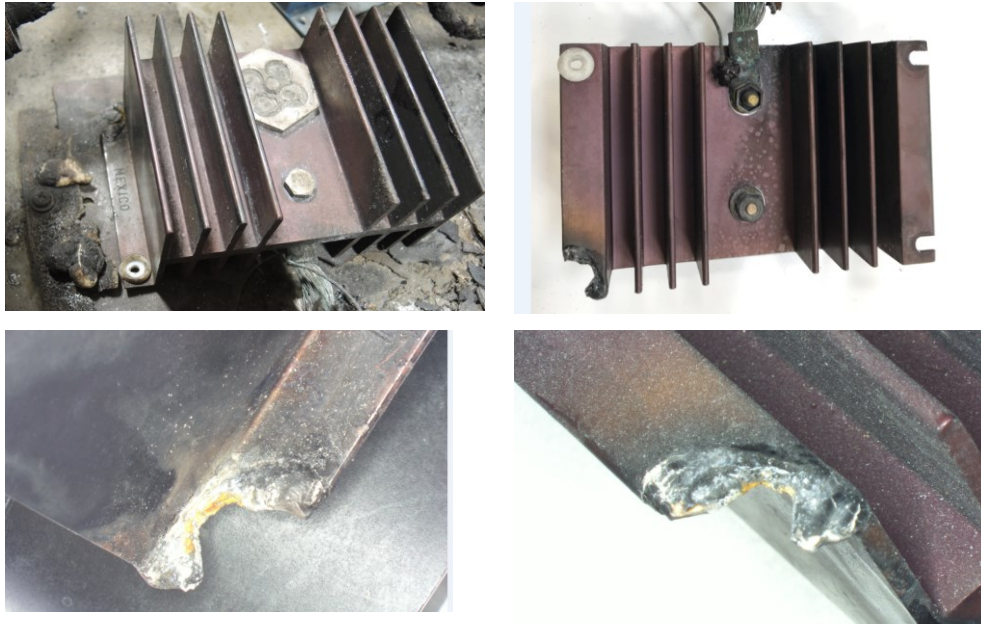
Figure 10 : radiateur métallique du dispositif à diodes après démontage (Source : BEA)
