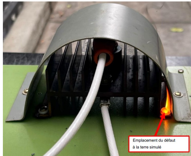
Figure 18 : positionnement du capot en ABS avec le point de fixation soumis à un échauffement intense (Source : CONCORDE BATTERY CORPORATION)
