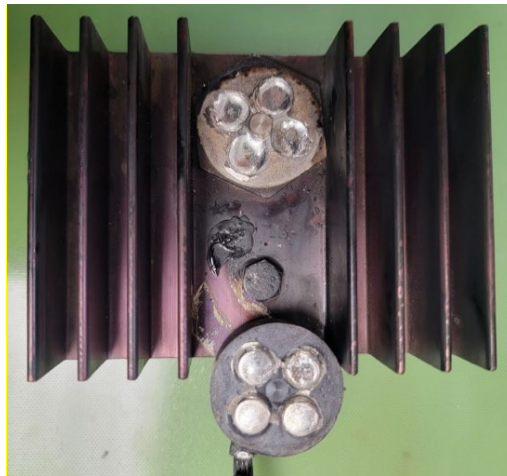
Figure 21 : séparation du pont de diodes du radiateur métallique (Source : CONCORDE BATTERY CORPORATION)
