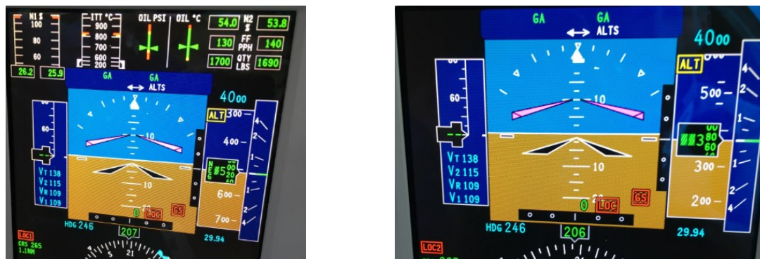
Figure 10 : MFD et PFD de droite sur lesquels sont affichées respectivement les informations de l'ADC1 et de l'ADC 2, au sol, après l'événement (source : BEA)
