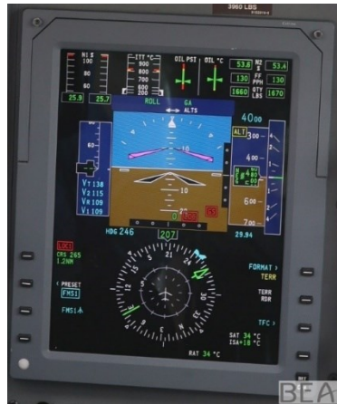
Figure 4 : MFD basculé en mode combiné du N222NF lors de la mise sous tension de l'avion quelques jours après l'événement (source : BEA)
