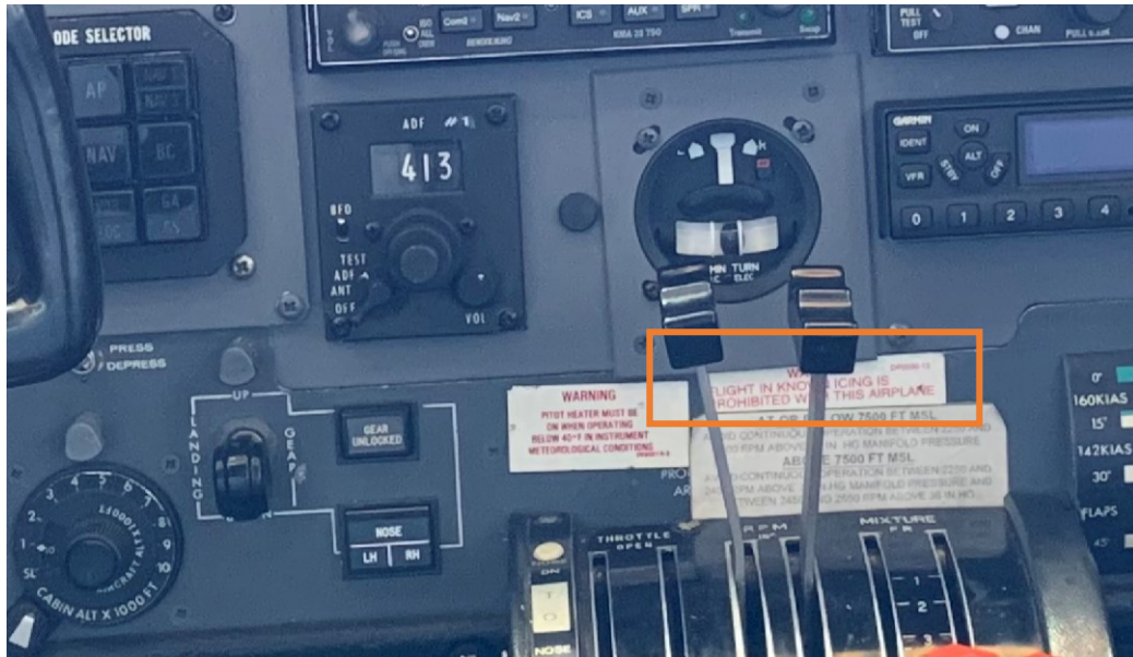
Figure 1 : panneau d'avertissement situé dans le poste de pilotage du N340YZ (Source : BEA)
