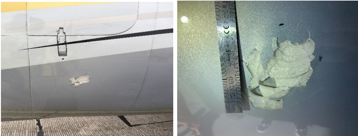
Figure 6 : photos de l'impact de glace sur le fuselage au droit du moteur gauche (Source : BEA)
