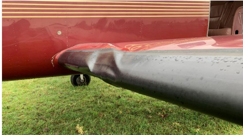
Figure 3 : endommagements à l'emplanture des ailes du N9190X (Source : BEA)
