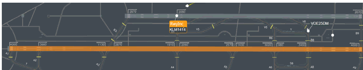
Figure 3 : information RwyInc associée à l'Embraer – Le Boeing n'est pas encore visible sur l'écran A-SMGCS (Source : DSNA)
