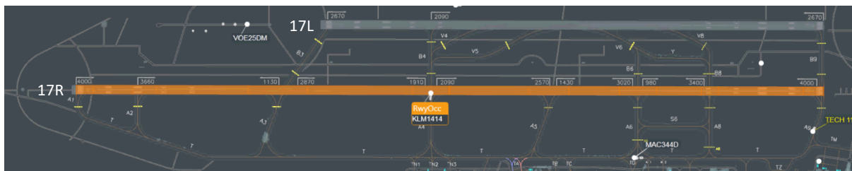
Figure 1 : information RwyOcc associée à l'Embraer lorsqu'il traverse la piste 17R, sur l'écran A-SMGCS (Source : Direction des Services de la Navigation Aérienne (DSNA))
