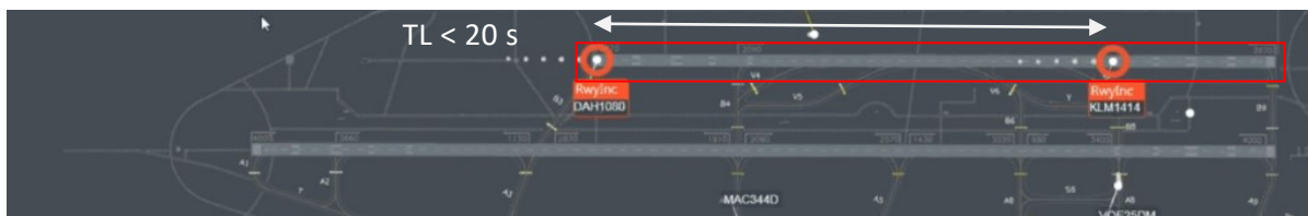
Figure 13 : alerte RwyInc sur le Boeing et l'Embraer lors que le Boeing entre dans la ZPP (Source : DSNA, annotations BEA)
