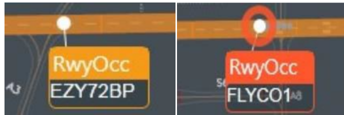
Figure 10 : aperçu des notifications de l'A-SMGCS (Source : consigne N°2022-032/SNA-CE/SE/C)
