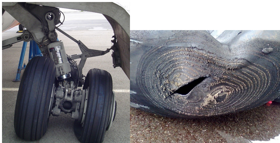
Figure 1 : Vue depuis l'arrière de l'avion du train d'atterrissage principal droit et vue d'une partie du pneu de la roue extérieure de ce train
