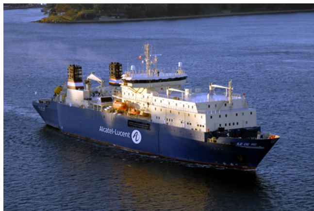
The Ile de Ré cable layer
