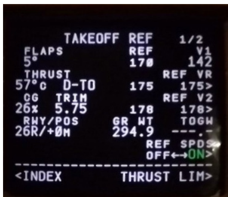
Figure 1 : exemple issu de simulation Vitesse de référence versus Vitesses insérées
