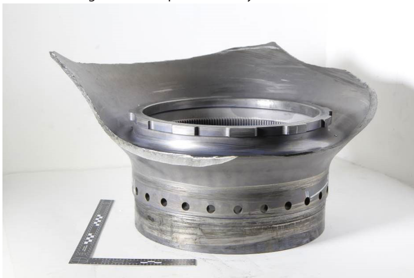
Figure 11 : Fragment du moyeu après sa dépose du moteur endommagé
