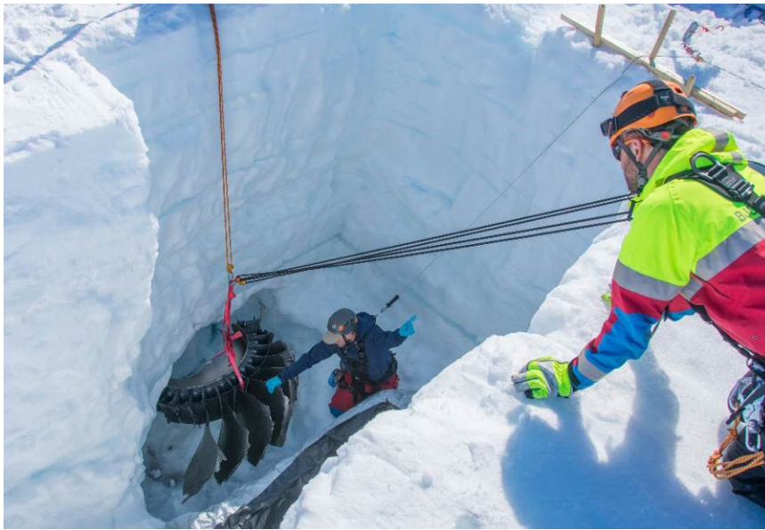
Figure 15 : Extraction du fragment de moyeu de soufflante
