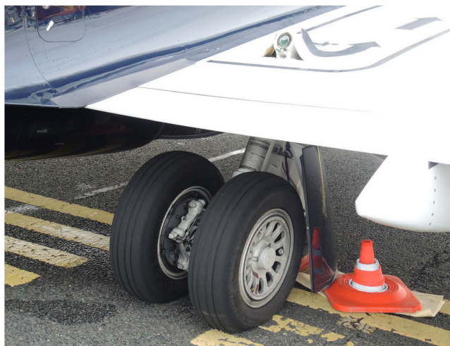
Figure 6 : Vue du train principal droit rompu en partie supérieure
