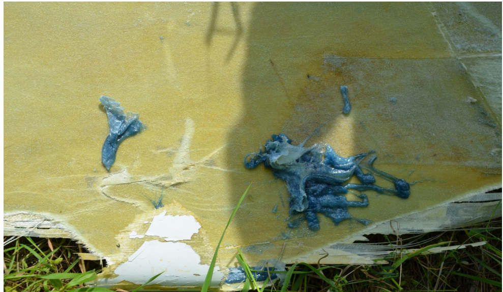
Figure 4 : morceau du revêtement d'intrados de l'extrémité de l'aile droite
