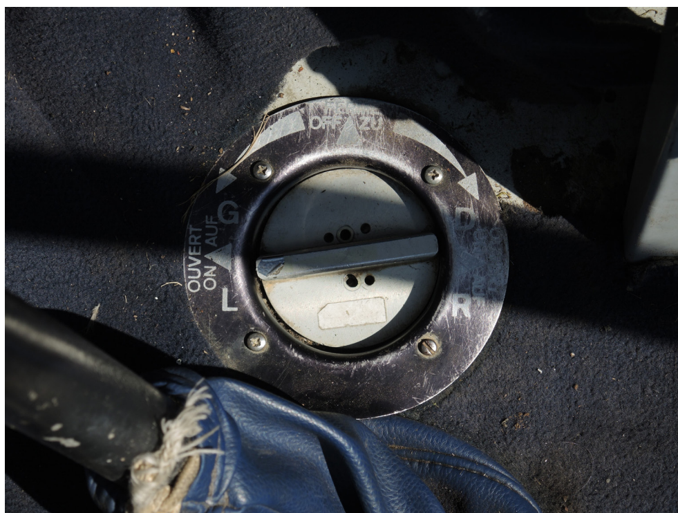
Figure 2 : photo du sélecteur carburant du F-GBCRmis sur la position « Gauche » après l'accident
