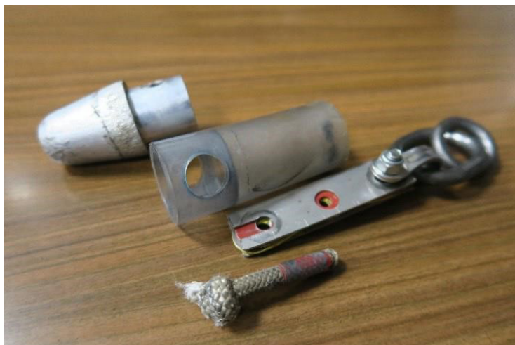
Figure 2 : extrémité du câble de remorquage, fusibles et gaine porte-fusible
