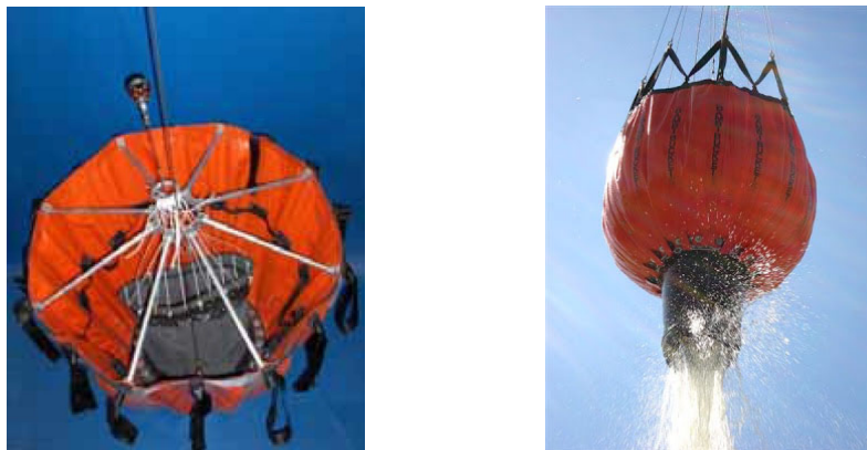
Figure 4 : Bambi Bucket prêt à l'écopage avec la vanne en position rentrée (à gauche) et en cours de largage avec la vanne déployée (à droite)
