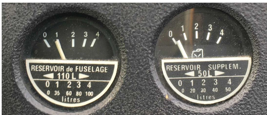
Figure 4 : Position des aiguilles à la mise sous tension avec les deux réservoirs vides
