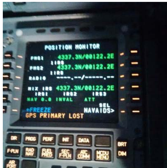
Figure 4 : exemple de la page POSITION MONITOR. Photo prise en simulateur. Notez le mode des IRS.
